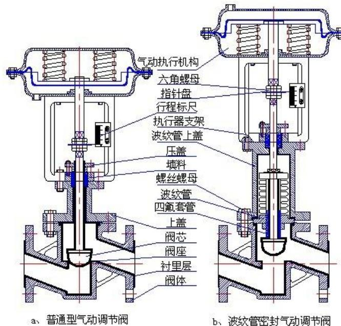
执行机构是气动调节阀生产过程自动控制系统的重要组成部分，其有正反两种作用形式，当信号压力增加，推杆伸出膜室的叫正作用，与阀配合构成气关式（如下图）当信号压力增加，推杆退出膜室的叫反作用，与阀配合构成气开式（如下图）。其原理：当信号压力输入膜室后，在膜片上产生推力，压缩弹簧，使推杆移动，带动阀杆，改变阀芯与阀座之间的流通面积，直到弹簧的反作用与信号压力作用在膜片上的推力相平衡，从而达到自动调节工艺参数之目的。
